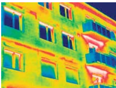
Bild: Energieagentur Graz Die Wärmeabstrahlung ist rot und gelb erkennbar.
