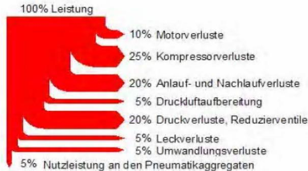
**Nur 5 - 8 % der eingesetzten elektrischen Energie wirkt als mechanische Energie am Druckluftwerkzeug**
