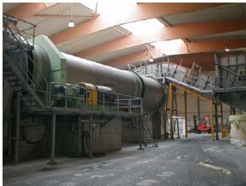
Abbildung 3-6: Hochkonsistenz-Auflösetrommel für Altpapier (Bildquelle: SCA Packaging)
