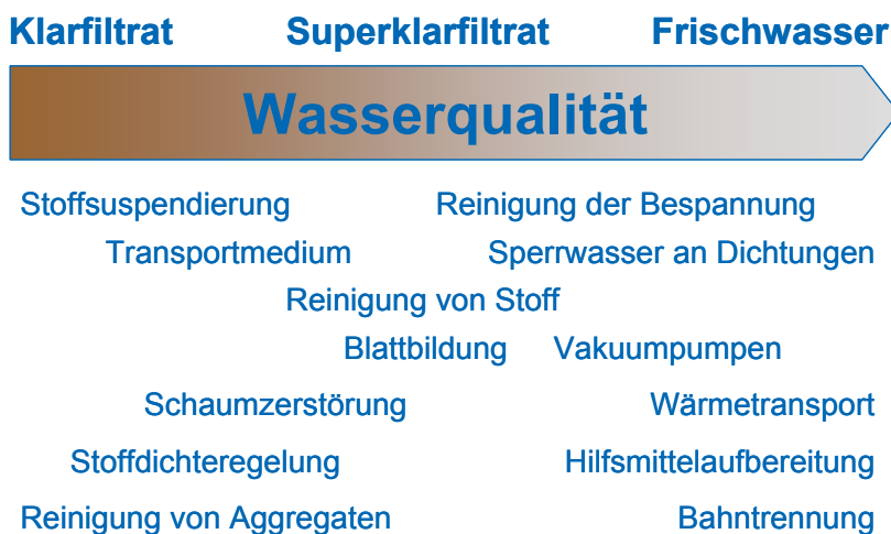
Abbildung 3-10: Aufgaben des Wassers bei der Papierherstellung [3-5]
