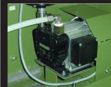
Drehschieberverdichter in der HSR 1000 (Quelle: Trützschler GmbH & Co. KG)
