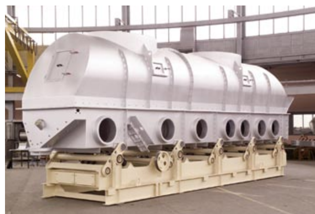
Diese Maschine wird zur Trocknung und Kühlung verwendet.
