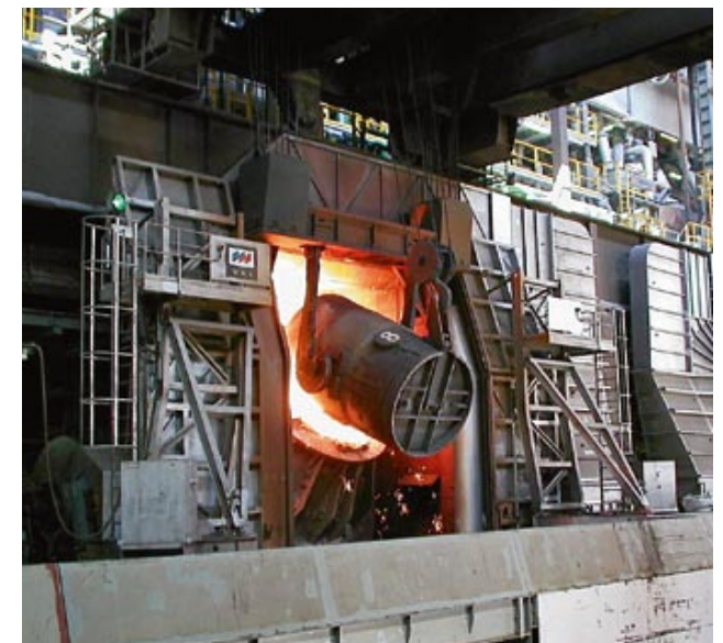
Füllvorgang des LD-Tiegels mit Roheisen.
