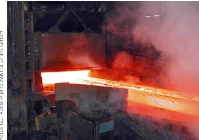
Ausstoßvorgang des auf ca. 1.200°C erwärmten Knüppels aus dem Hubbalkenofen.
